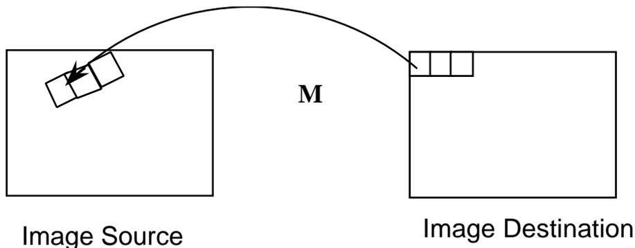
Pour chaque pixel de l'image de destination  $(x_d, y_d)$ , on calcule une position  $(x_s, y_s)$  dans l'image de la source.
